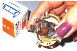
Die Funktionsweise der primär in Europa eingesetzten Leuchtmittel mit zwei Glühwendeln ist relativ einfach. Die beiden Glühwendeln sind hintereinander angeordnet. Dabei befindet sich nur die Glühwendel für das Fernlicht exakt im Brennpunkt. Die Glühwendel für das Abblendlicht ist etwa 1 cm vor dem Brennpunkt und 3 mm oberhalb der Achse des Reflektors positioniert.
