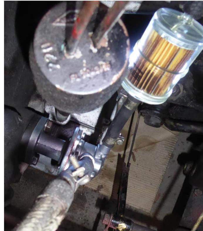
**Kraftstoffpumpennocken mit dem Motor auf Nullhub gedreht,
