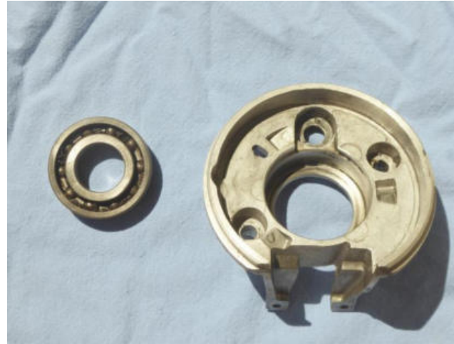
Lenkungslager (6004 20x42x12) und Führungsplatte : Achtung Platte entspricht nicht der Zeichnung auf Seite 1, Lager wird von hinten abgestützt
