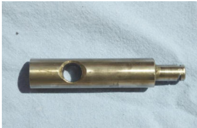
Führungszapfen herausgenommen, gereinigt und neu gefettet
