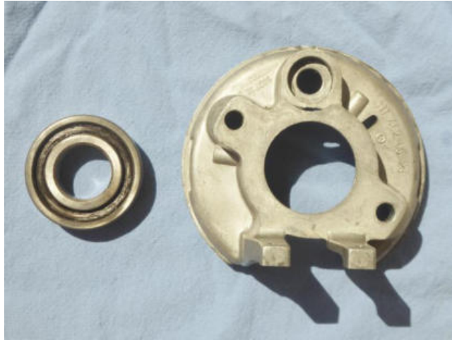
Lenkungslager (6004 20x42x12) und Führungsplatte : Achtung Platte entspricht nicht der Zeichnung auf Seite 1, Lager wird von hinten abgestützt
