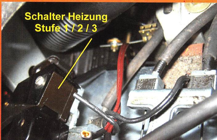
Um dies alles zu finden, muss man das Radio ausbauen, den Ascher komplett herausziehen und auch den Frontlautsprecher inklusive Abdeckung demontieren. Jetzt findet man schon fast alles.
