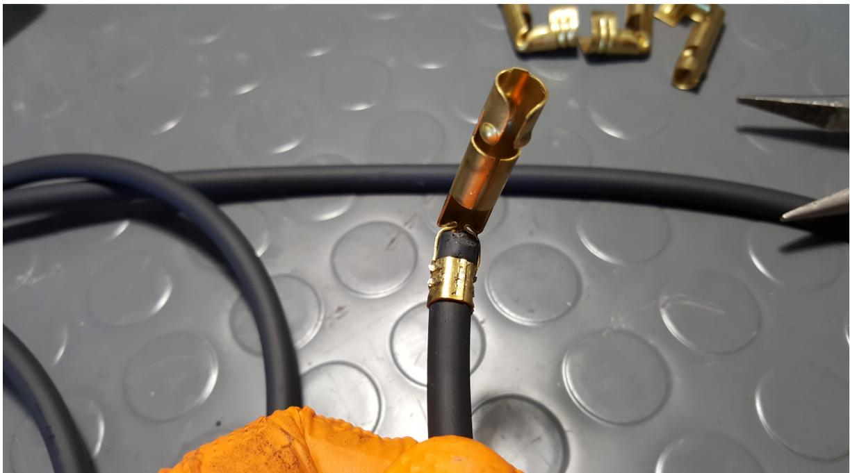
und sitzt feste im Schuh. Zur Probe mal sanft dran ziehen, es darf natürlich nicht rausrutschen. Bei dieser Konfektionierung hat alles auf Anrieb geklappt. Die Gummitülle
