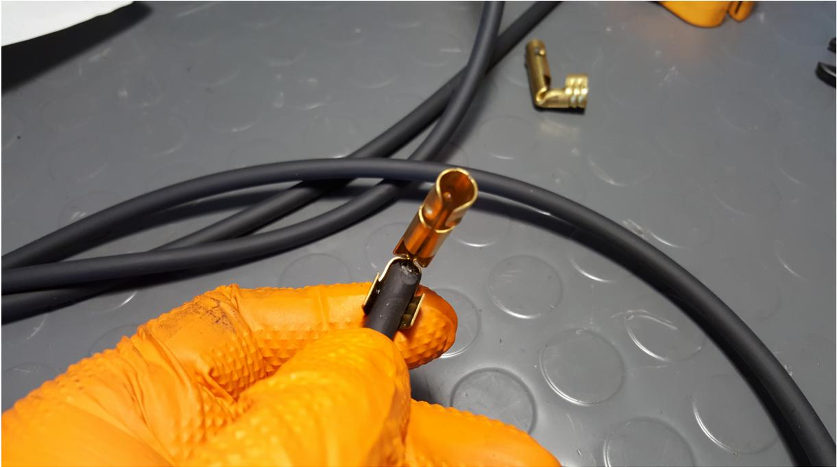
Mit einer Flachzange kneift man den einen Schenkel des Kabelschuhs um, und anschliessenden den anderen:
