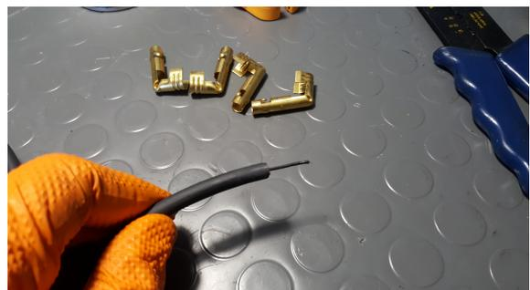
Der herausstehende Leiter wird nun u-förmig umgebogen und das Kabel in den Kabelschuh eingelegt
