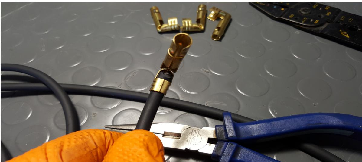
Das ist der richtige Moment, eine Kabelcrimpzange einzusetzen, die gibt es in jeden Baumarkt. Die Zange hat ein kleines Zündkerzensymbol aufgedruckt, so dass man dort die entsprechende Pressung vornehmen kann. Der Kabelschuh wird eingelegt und an zwei Stellen gequetscht.
